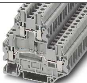
28 А, диодная двухъярусная клемма, 1N 4007 (1300 В/0,5 А)
